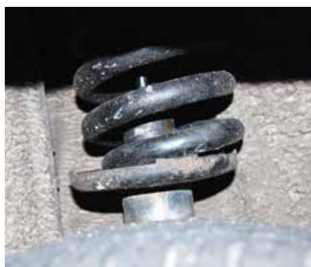
FJÆRINGER: Bilens fjærer blir stivet opp slik at bilen ikke gir etter for overvekten.
